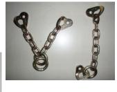
Pour les différents type d'équipement, ne pas mélanger les matériaux au niveau des ancrages (inox, galva, acier, bi-chromaté ...) afin d'éviter les réactions chimiques.
